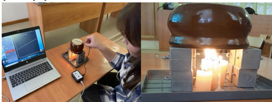
При выполнении данного проекта ребята пришли к выводу о том, что необходимо над конвекционным потоком воздуха ставить ловушку для лучшего обогрева комнаты. Данный проект позволит ребятам использовать свечной обогреватель в чрезвычайных ситуациях.
